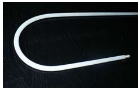
Рис. 3. Изгиб стержня заземлителя ИГУР на 180^\circ без растрескивания и отслоения цинкового защитного слоя
